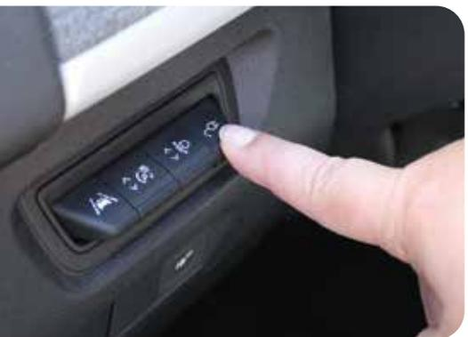
Bevor Sie Laden können, müssen Sie zunächst bei einigen E-Autos die Ladebuchse entriegeln. (Beispiel Renault Zoé: Schalter links neben dem Lenkrad). Da dies von Auto zu Auto unterschiedlich gelöst ist, haben wir dazu kurze, erklärende Videos gedreht, die Sie auf unserem YouTube-Kanal finden (Link auf der letzten Seite).
