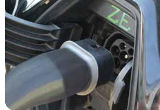
Stecken Sie das andere Ende des Ladekabels mit dem passenden Stecker in die entsprechende Buchse der Ladesäule.
